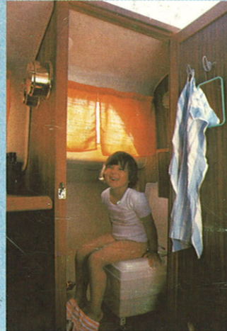
Separat toalettutrymme med kemtoa (med tank). Kan kompletteras med handfat.
